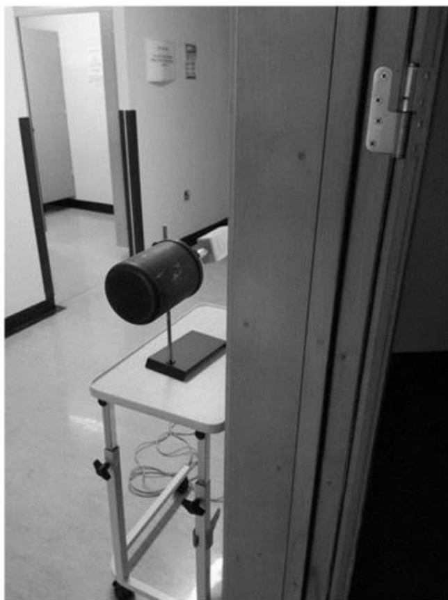
شکل ۷-۸. اندازه‌گیری میزان عبور پرتو از طریق دیوار با استفاده از یک اتاقک یونیزاسیون حجم بالا.
