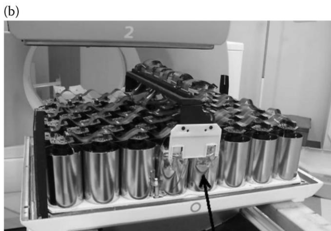
شکل ۵-۸. (a) لوله تقویت کننده نوری (PMT)؛ (b) آرایه‌ای از PMT ها در پشت کریستال سوسوزن.
