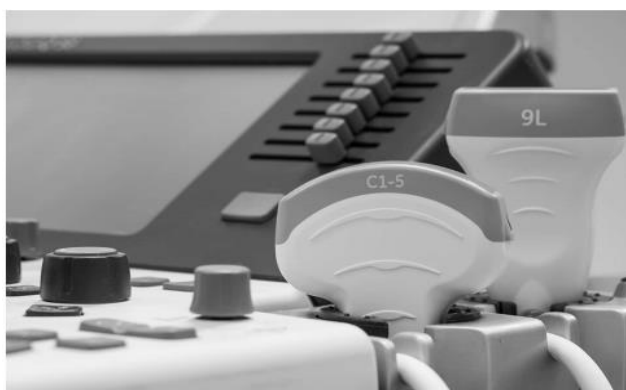
شکل ۳-۵. پروب‌های فراصوت دارای آرایشی از عناصر مبدل هستند که برای کاربردهای بالینی خاص بهینه شده‌اند.
