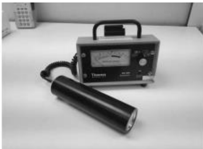
شکل ۷-۹. مانیتور آلودگی مجهز به آشکارساز سنتیلاسیون و سرعت سنج، که نرخ شمارش در واحد زمان (cps) را نشان می‌دهد.
