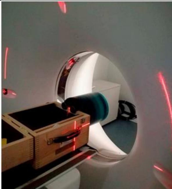
شکل ۴-۱۳. Catphan® برای ارزیابی کیفیت تصویر CT استفاده می‌شود.
